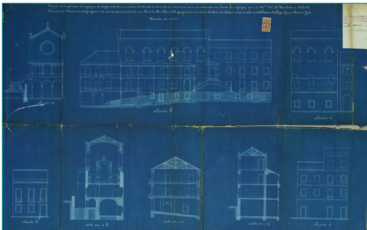
Figura 6 Ampliação da zona da capela e construção da escada de acesso.
