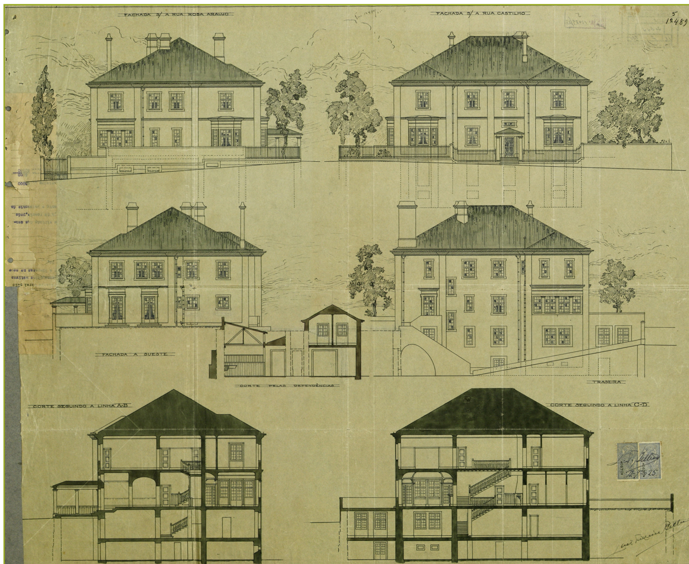
Figura 11 Projeto de casa para o Exmo Snr. Max Abecassis. Alçados e cortes. Raul Lino (1925). AML, Obra n.º 1181 , Processo n.º 12489/DAG/PG/1925, f. 5.
