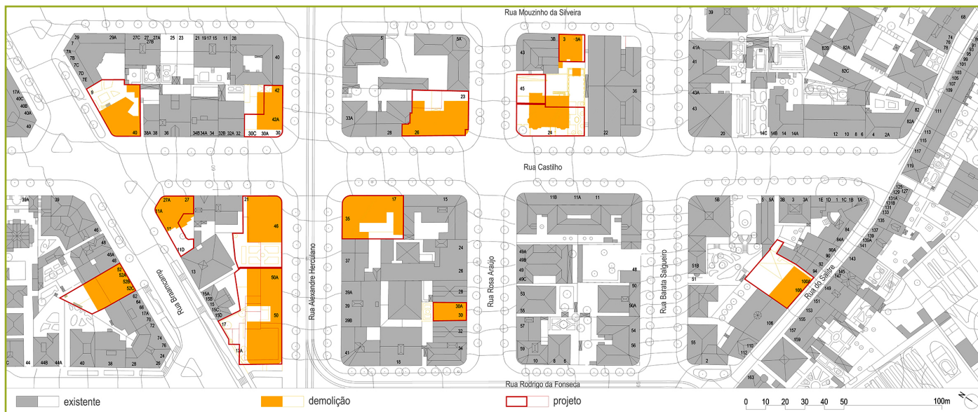
Figura 20 Planta de 1970 (s. esc.), Paulo Manta Pereira (2016). [Desenho sobre cartografia digital da CML].
