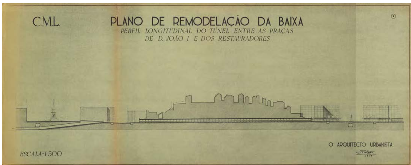
Plano de remodelação da Baixa elaborado pelo arquiteto urbanista Faria da Costa, na Direcção dos Serviços de Urbanização e Obras. Inclui as plantas do conjunto e o perfil longitudinal do túnel a ser projetado entre as praças de D. João I e dos Restauradores, 1949-1950. AML, PT/AMLSB/CMLSB/UROB-PU/10/432, p. 4.
