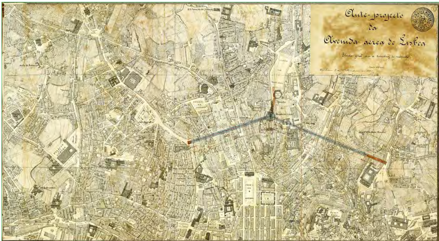
Anteprojecto da Avenida Aérea de Lisboa, um viaduto metálico a ligar São Pedro de Alcântara ao Campo dos Mártires da Pátria e, deste ponto, à Graça. Contém planta geral, alçado e perfil geral, desenho dos apoios dos arcos e pilares, resumo gráfico dos alinhamentos do projeto, caderno de encargos, memória descritiva e officios, 25-07-1888 – 02-09-1888.
