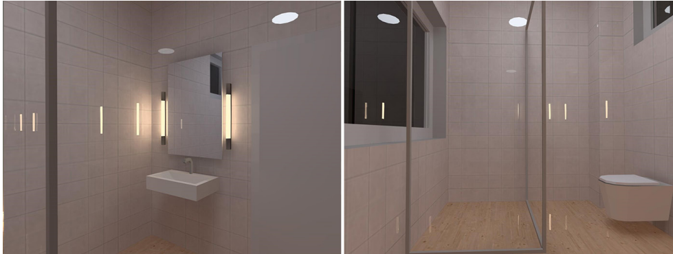
FIGURA 6 Simulação da iluminação I.S. – software Dialux EVO
