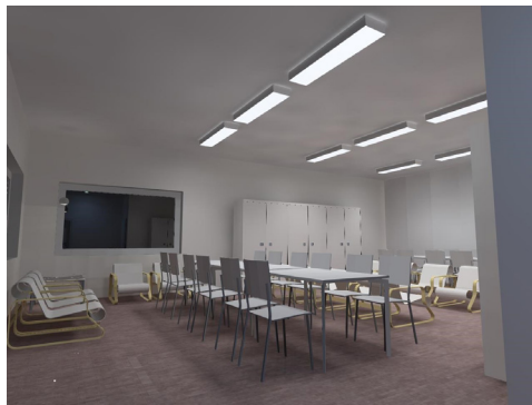
FIGURA 9 Simulação da iluminação da sala de Terapia ocupacional – software Dialux EVO
