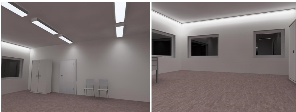
FIGURA 7 Simulação da iluminação da sala de fisioterapia – soft- ware Dialux EVO
