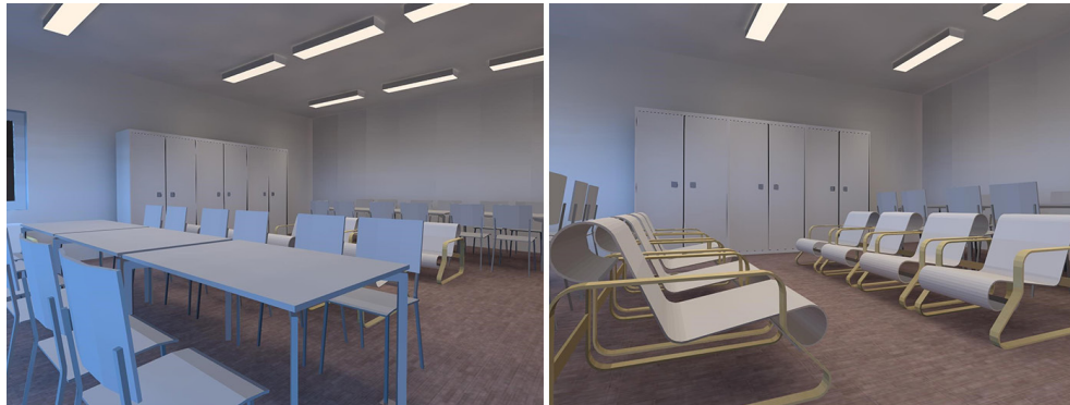
FIGURA 8 Simulação da iluminação da sala de Terapia Ocupacional – software Dialux EVO
