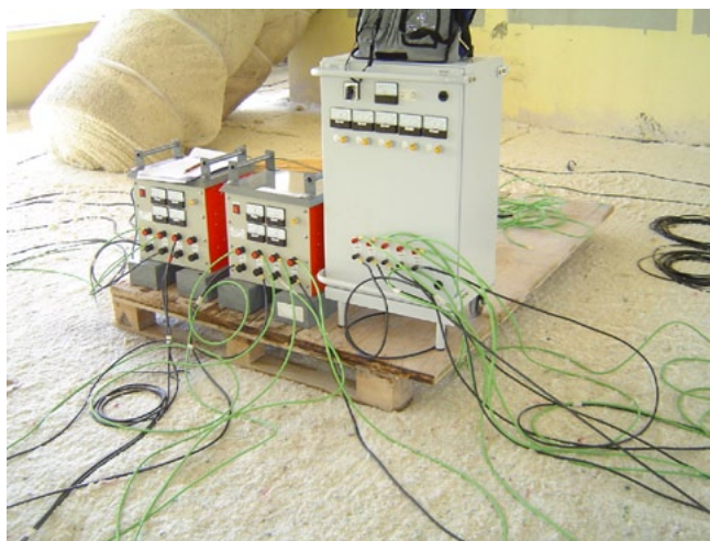
Fig. 5- Exemplo das ligações às fontes de alimentação.
