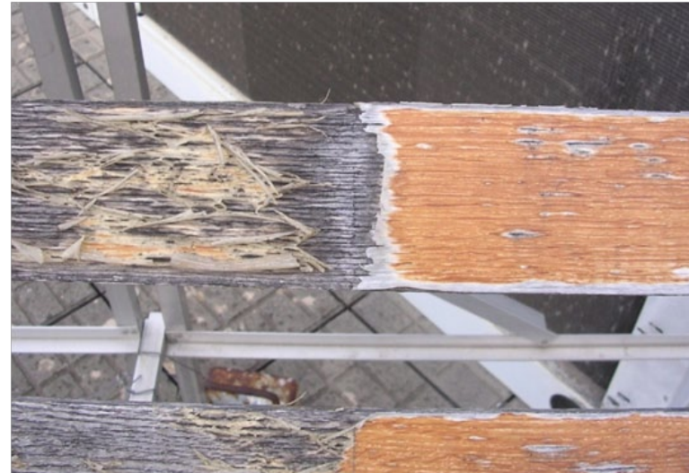
Fig. 17 - Amostra de madeira de carvalho com aplicação de verniz poliuretano em uma demão (lado esquerdo) e duas demãos (lado direito), após três anos de exposição ao exterior.
