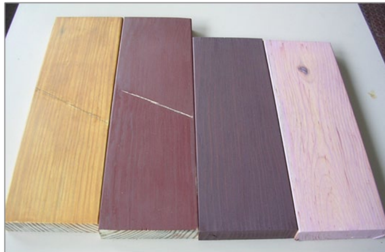
Fig. 20 - Solução cores com diferentes níveis de filtragem de radiação UV-A e aditivos para melhorar os tempos de secagem.
