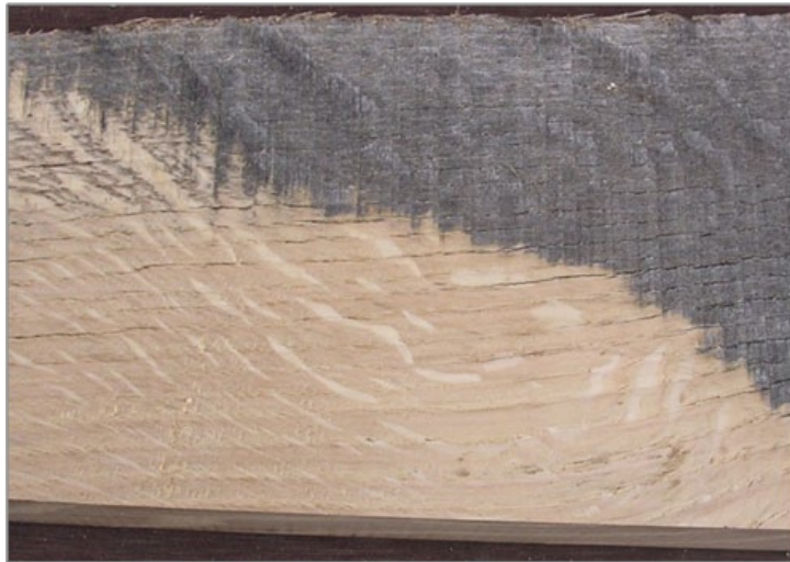
Fig. 10 - Aparência visual e estado de conservação de uma peça de carvalho a diferentes níveis de afastamento da superfície exposta ao exterior.
