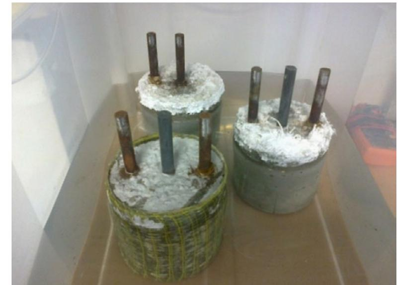
Fig. 2 – Provetes em imersão parcial numa solução de 5% de NaCl.
