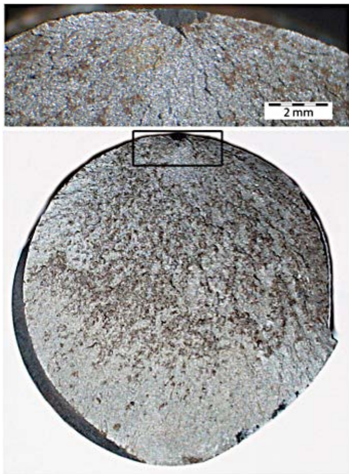
Fig. 5 - Superfície de fratura e pormenor no local de iniciação da fissuração.
