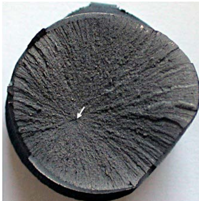
Fig. 6 - Superfície de fratura resultante de ensaio de tração da armadura até rotura.
