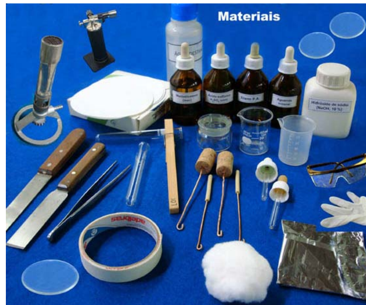
Fig. 2 – Visão geral dos materiais necessários para a realização dos ensaios de identificação de tintas.
