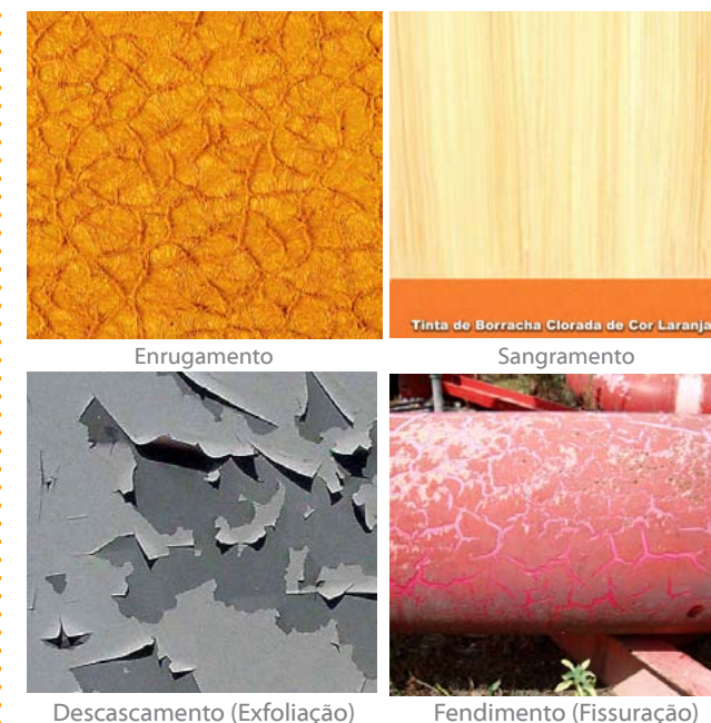
Fig. 1 – Falhas de compatibilidade entre esquemas de pintura.
