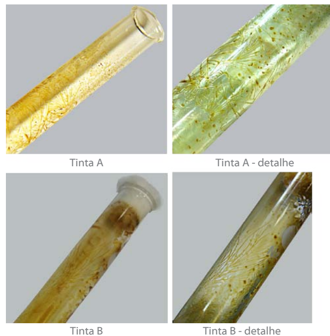
Fig. 14 – Material em forma de “agulhas”, na parede interna de tubos de ensaio, após o processo de pirólise de amostras de películas de tintas alquídicas (A e B).
