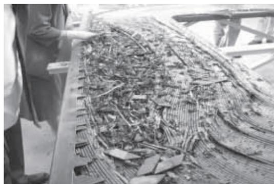
**Fig. 1.** Pormenor dum enrolamento dum transformador (após desmontagem), com um defeito grave (arco eléctrico entre espiras), originado pela presença de sulfureto de cobre
