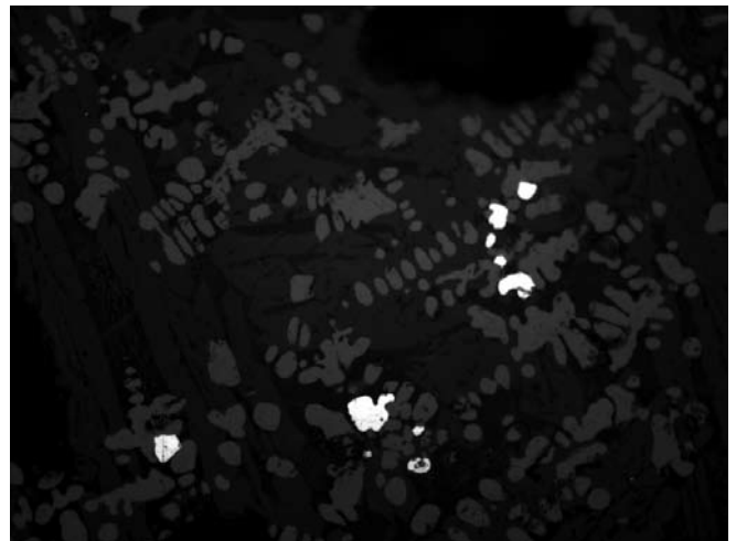
Fig. 20. Pormenor da figura 19 mostrando grãos de ferro metálico crescendo na interface das dendrites de wustite. Amostra 4. Amp. 500x
