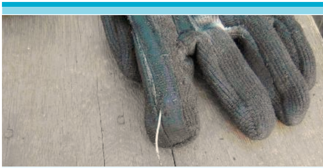
Figura 1: Fio de aço solto na luva com CA 14205.
