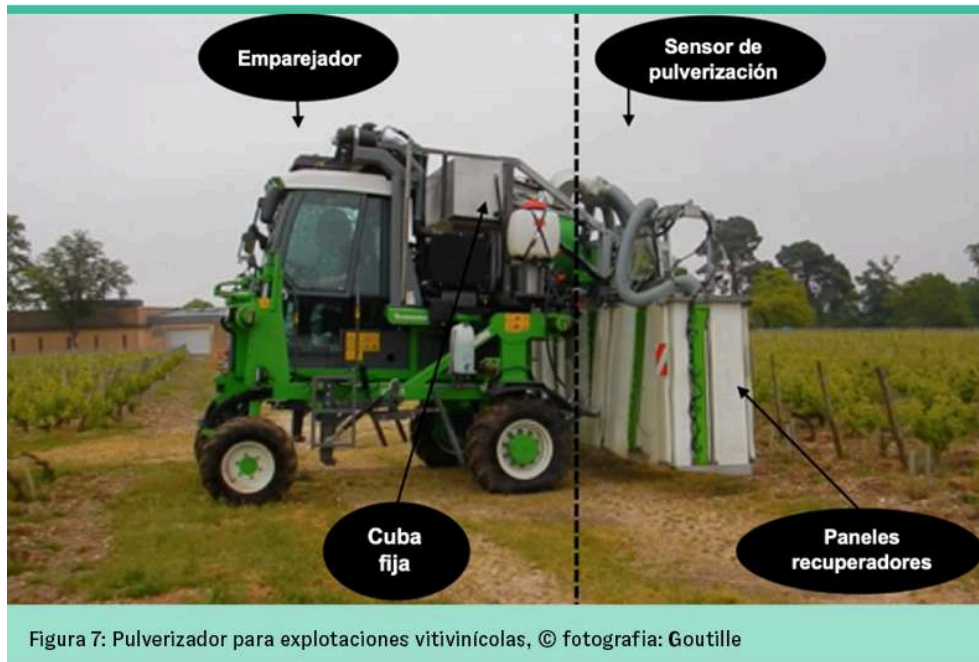
Figura 7 : Pulverizador para explotaciones vitivinícolas. Fotografía : Goutille
