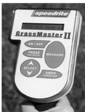
Figura 1 – Consola da sonda de capacitância “GrassMaster II” (à esquerda); medições numa caixa de exclusão de pastoreio durante o ensaio (à direita).
