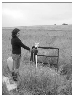
Figura 1 – Consola da sonda de capacitância “GrassMaster II” (à esquerda); medições numa caixa de exclusão de pastoreio durante o ensaio (à direita).
