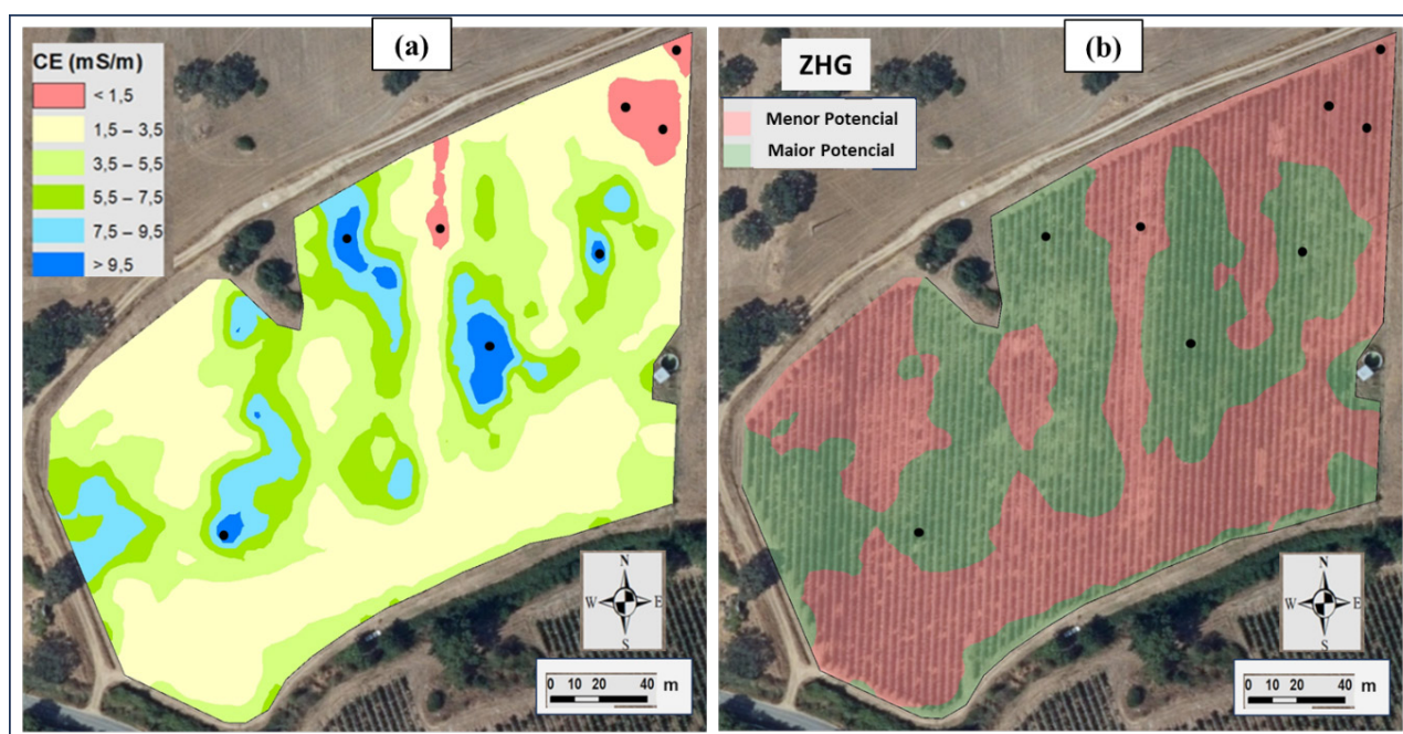
Figura 3 - Mapa da condutividade elétrica do solo, CE (a) e das zonas homogêneas de gestão, ZHG (b) da parcela de uvas tintas da Herdade da Mitra. É indicada a localização dos pontos de amostragem do solo (4 em cada ZHG).
