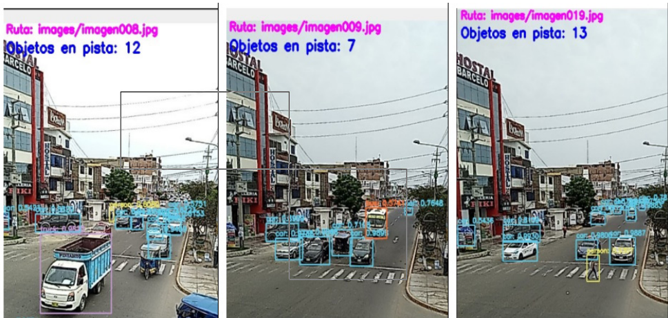
Figura 4 – Detección y conteo de vehículos en tiempo real
