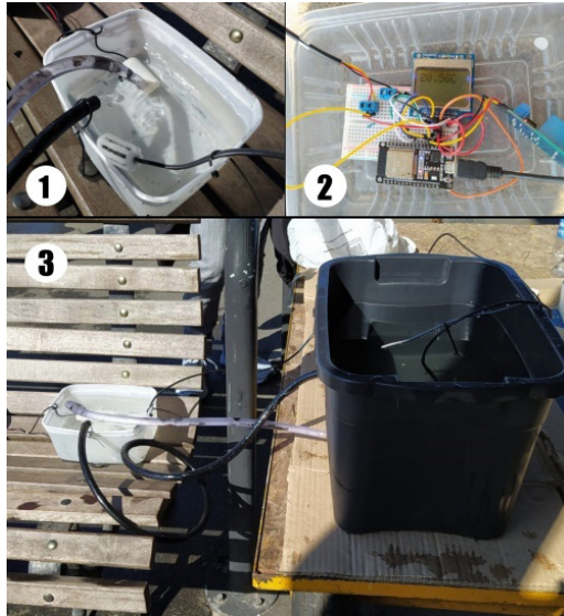
Figura 3 – Montagem do protótipo para validação do projeto. (1) Aquecimento e bombeamento de água. (2) Controle elétrico do protótipo. (3) Posicionamento para realização dos experimentos.
