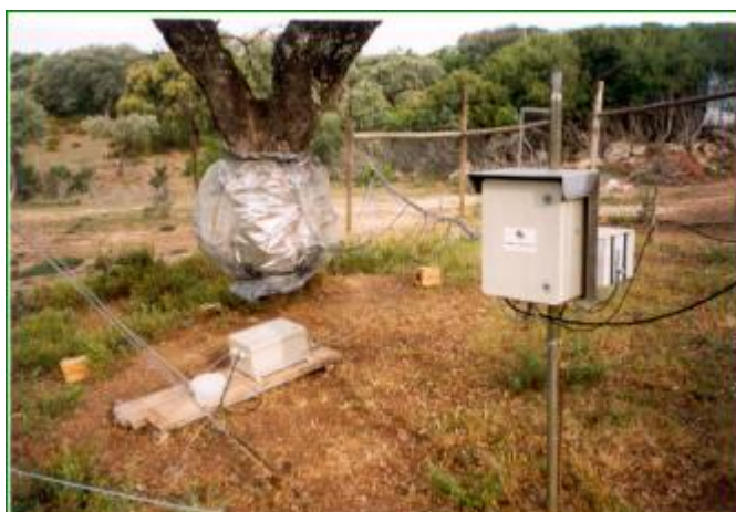
Figura 1 - Aspecto geral do sistema de medição do fluxo de seiva (transpiração)
