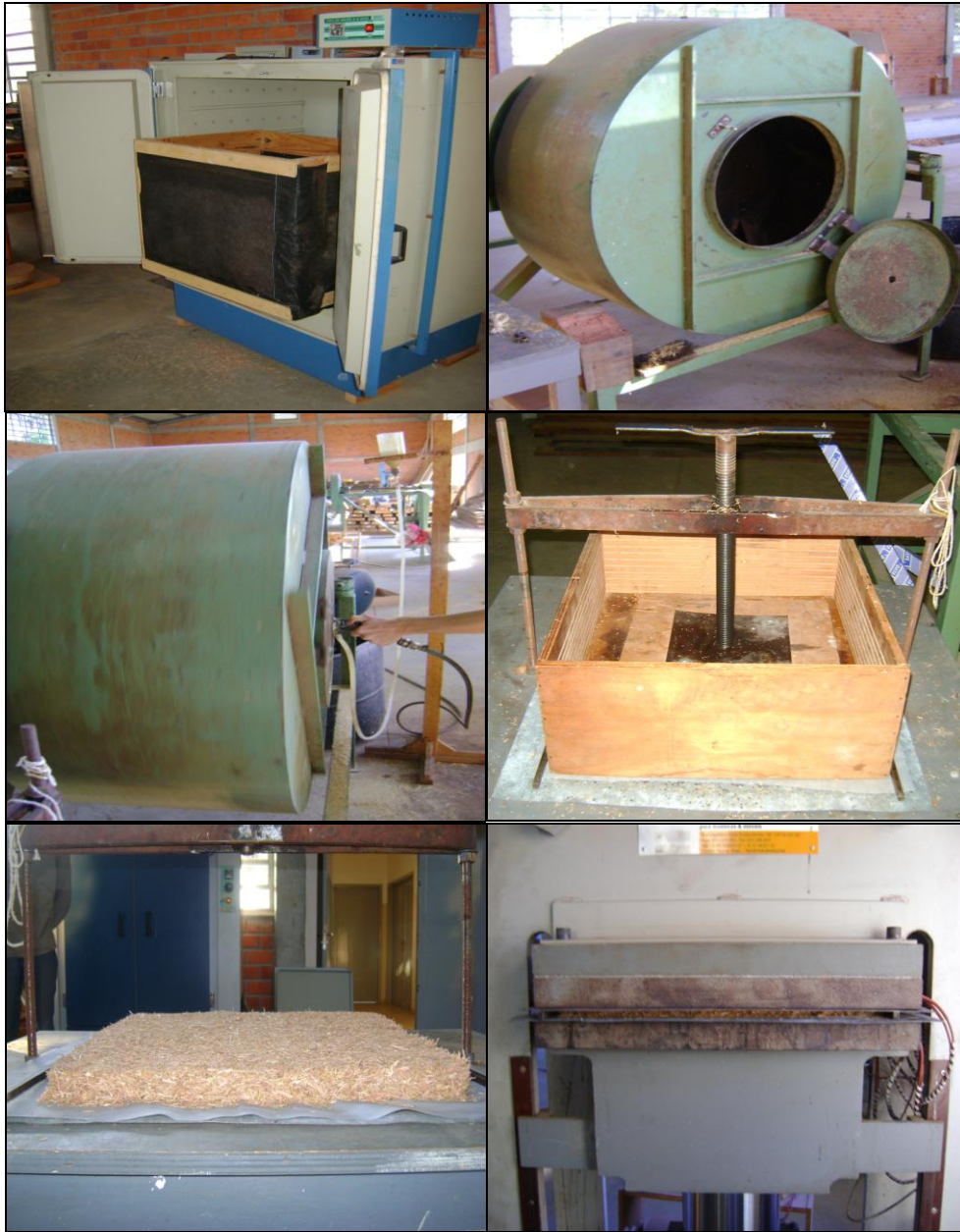
Figura 2 - Sequência adoptada no processo produtivo dos painéis. Da esquerda para direita: secagem das partículas em estufa; tambor rotativo; aplicação do adesivo/parafina/água; prensagem manual a frio do colchão em caixa formadora; colchão pós-prensagem manual; e prensagem definitiva a quente em prensa hidráulica
