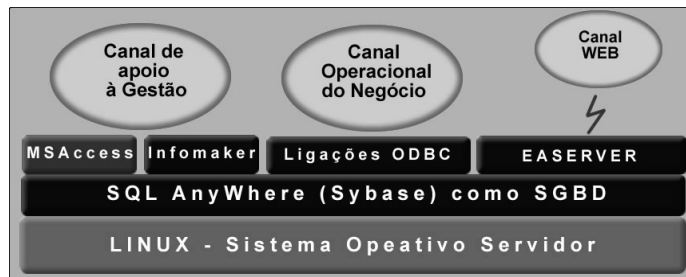
Figura 5 - Arquitectura do sistema onde o canal web, o canal interno ou operacional e o canal para a gestão partilham a mesma infra-estrutura assente em linux
