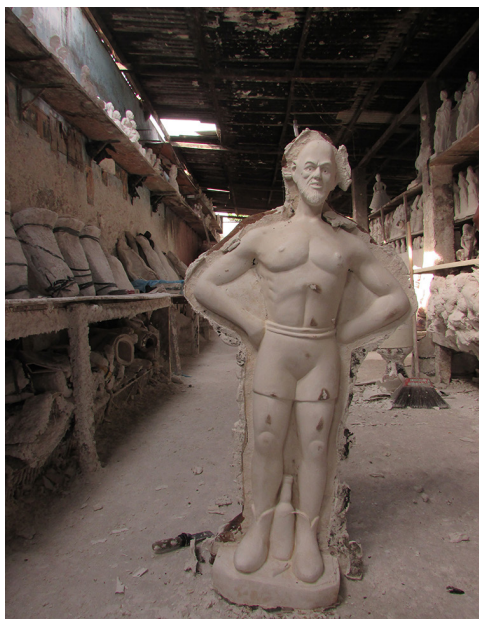
Figura 6 – Imagem após ser retirada do molde, antes da desbastagem. Fonte: Morena Freitas, abril de 2016, Mesquita/RJ, Brasil.
