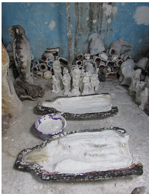
Figura 4 – Preenchimento do molde com gesso ainda líquido, sobre fibras de vidro. Fonte: Morena Freitas, abril de 2016, Mesquita/RJ, Brasil.
